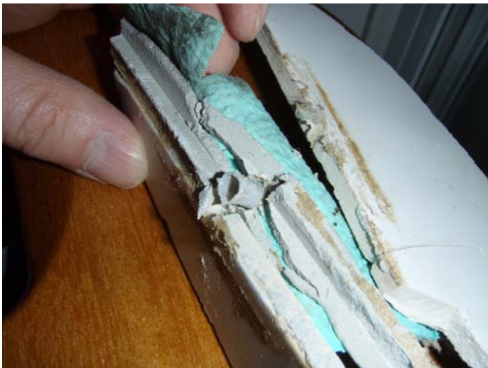
Fotografi 26. Ingen silikon i borrhål, plugg eller i anslutning till tätskiktet (mätpunkt 2).
