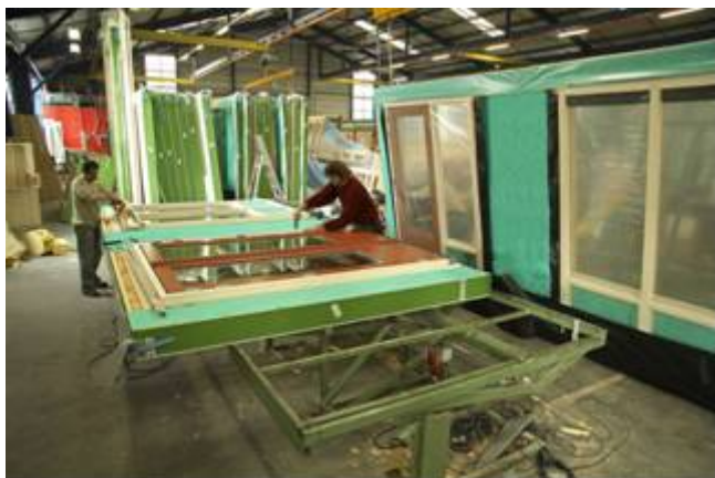
Figur 2. Utfackningsvägg med hög prefabriceringsgrad som tillverkas på fabrik i Holland
