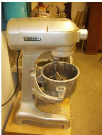
Figur 4.1 Hobart-blandare för tillverkning av cementbruk.
