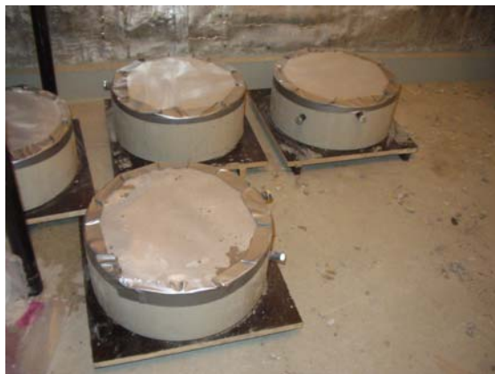
Figur 7.2 Membranhärdning av provkroppar genom försegling av överytan
