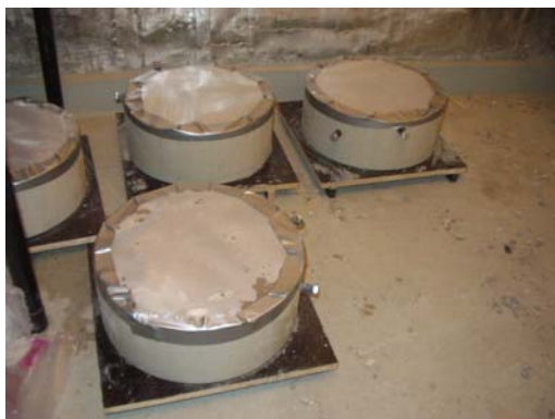
Figur 5.6 Membranhärdning av referensprovkroppar.
