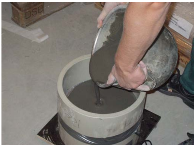
Figur 7.4 Applicering av avjämningsmassa på betongprover.
