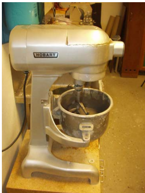
Figur 7.3 Blandning av avjämningsmassa i Hobart-bruksblandare.
