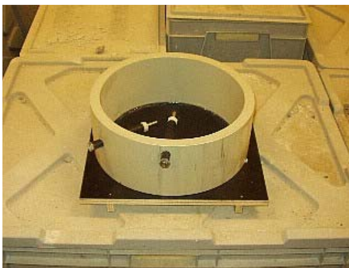
Figur 5.3 Gjutform på bottenplatta med monterade mätrör och bultar.
