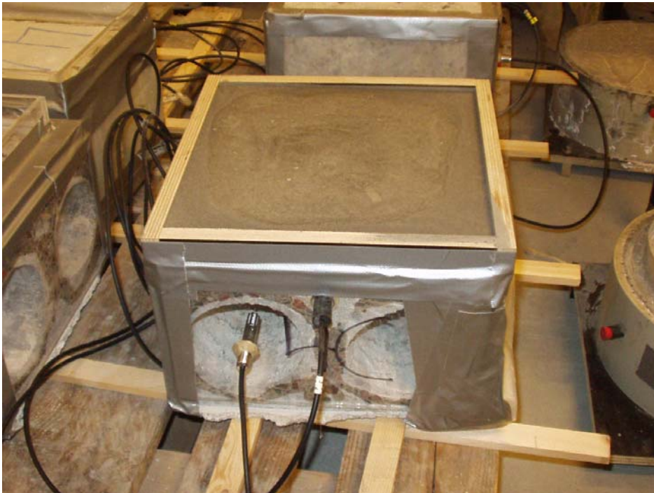
Figur 8.7 Placering av RF-givare i HD/F-bjälklag.
