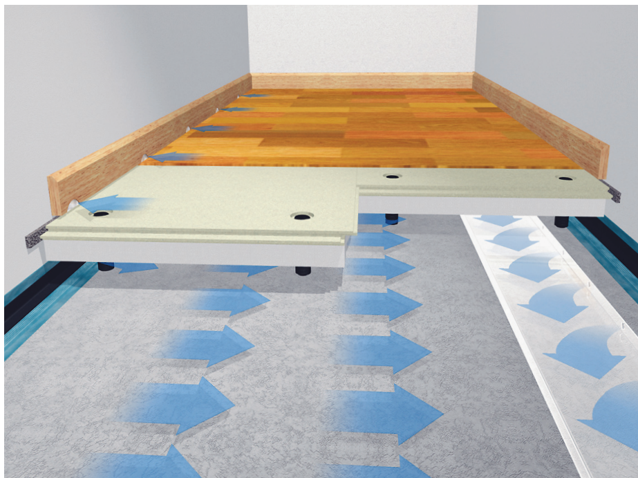
Mekaniskt ventilerat golv, Giha Golvsystem, där luftspalten byggs upp med hjälp av golvspånskivor som står på distansskruvar. Pilarerna visar hur luften strömmar ned i golvet via luftintagen, vidare genom golvet och ut via frånluftskanalen.
