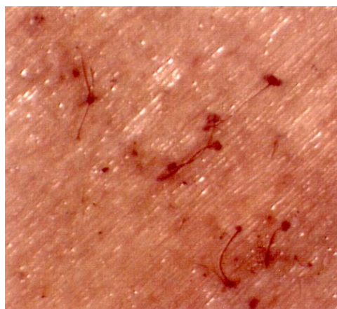
Bild 7.5 Påväxt syns inte alltid. På bilden till vänster syns inte mögelpåväxten för blotta ögat. Bilden till höger visar däremot att mögelpåväxt finns på träbiten om man tittar i lupp/mikroskop.
