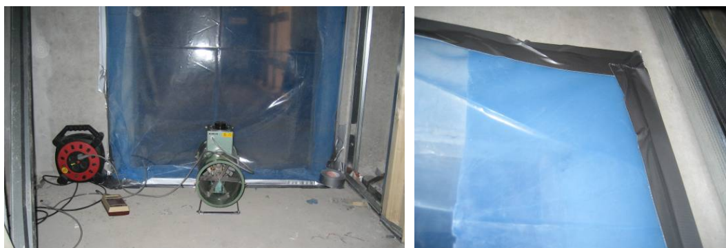
Figur 12 Fläkt och manometer monterade i dörr mot trapphus, tätning kring dörr.
