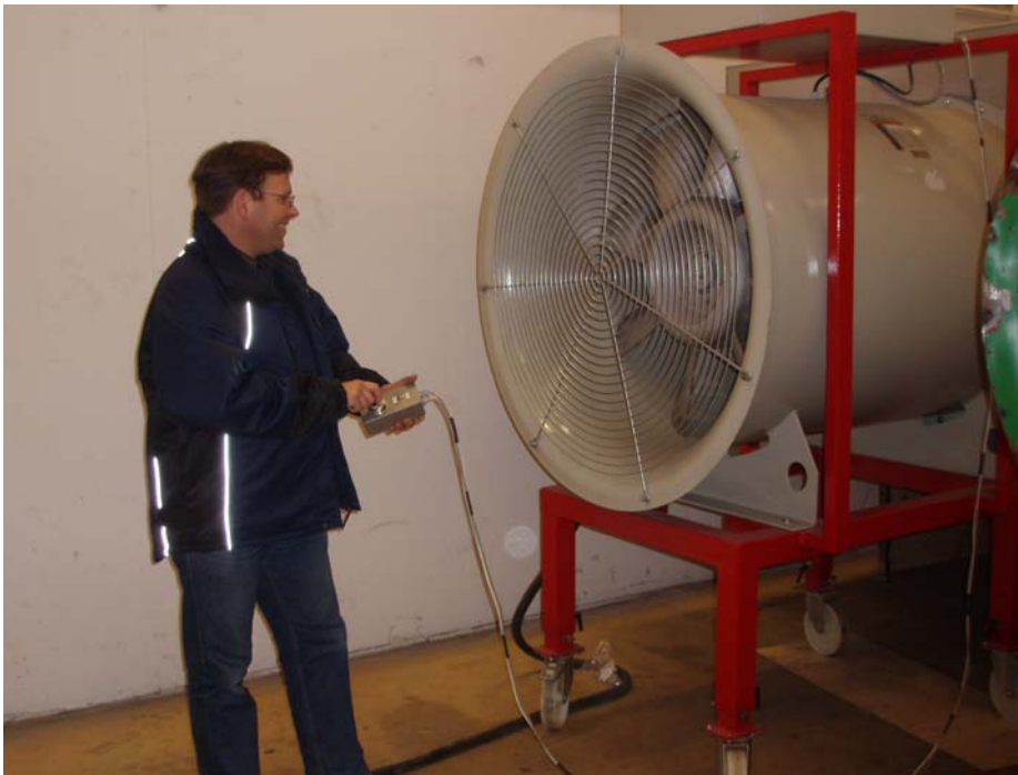
Figur 4.3 Täthetsprovning med en stor fläkt vars kapacitet klarar stora byggnader såsom industrierhallar, kontorsbyggnader mm.
