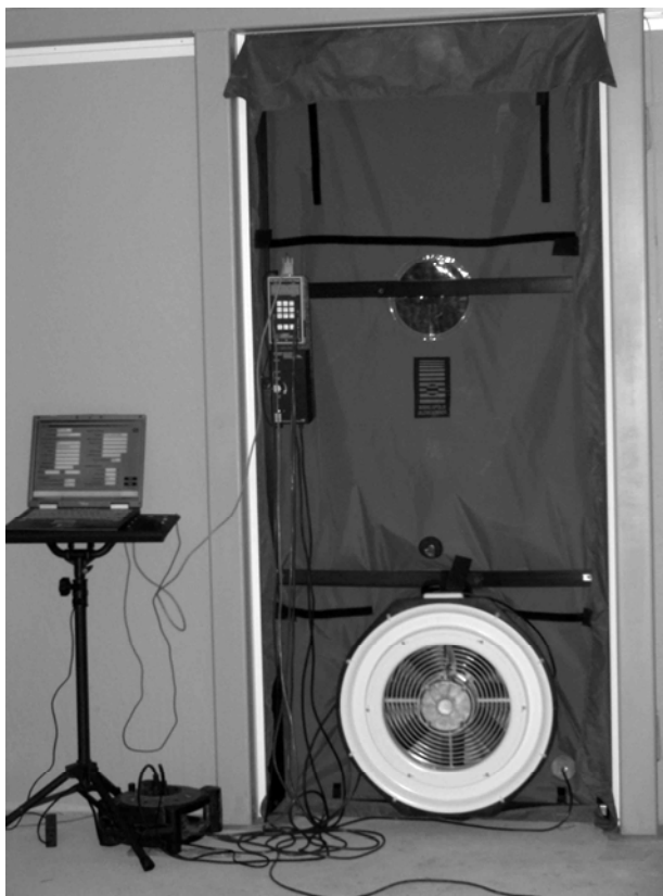
Figur 8 Utrustning för mätning av en byggnads täthet.
