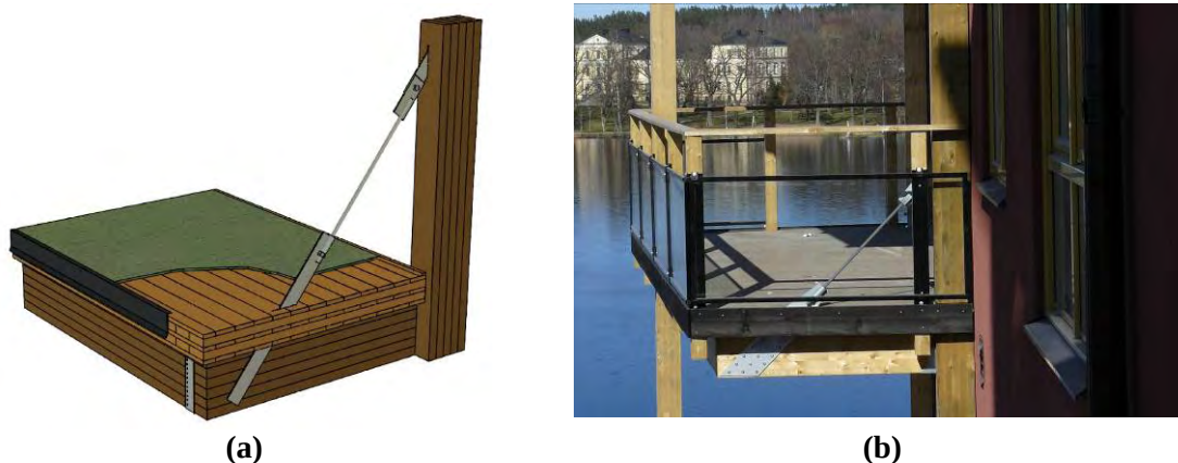
Figur 8. Balkonger (a) principutförande för balkonger på norra sidan, (b) färdig balkong.
