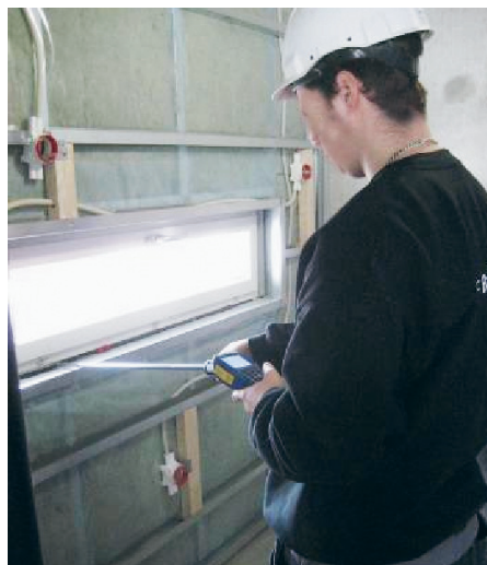
Figur 5: Läcksökning med värmekamera, luft hastighetsmätare och rökgas.
