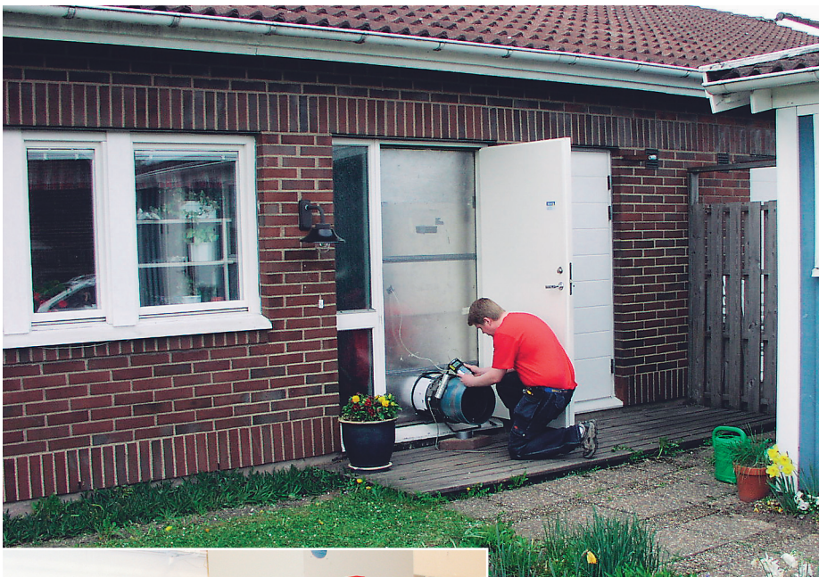
Figur 5: Täthetsprovningar utförs med hjälp av fläktar som placeras i en öppning i fasaden. Med hjälp av fläkten skapas ett undertryck respektive övertryck över byggnadsskalet. Läckagesökning med hjälp av värmekamera kan utföras i samband med undertrycket. Det finns fläktar med mindre kapacitet lämpade för små byggnader samt fläktar med stor kapacitet som är lämpade för stora byggnader och hallar.
