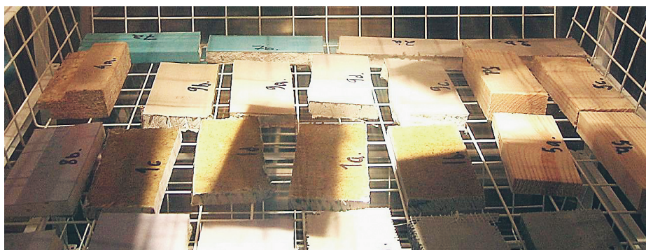
Provbitarna lades in i ett klimatskåp med 22 °C i tre omgångar; vid 95, 90 respektive 85 procent RF.
