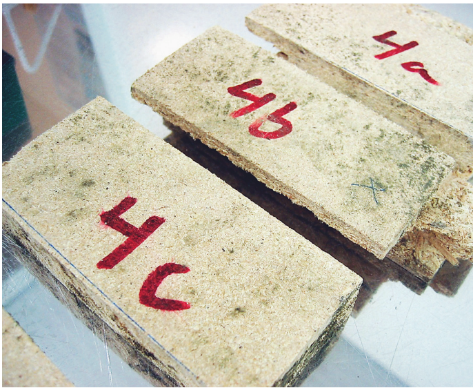
Spånskiva med synlig påväxt.
