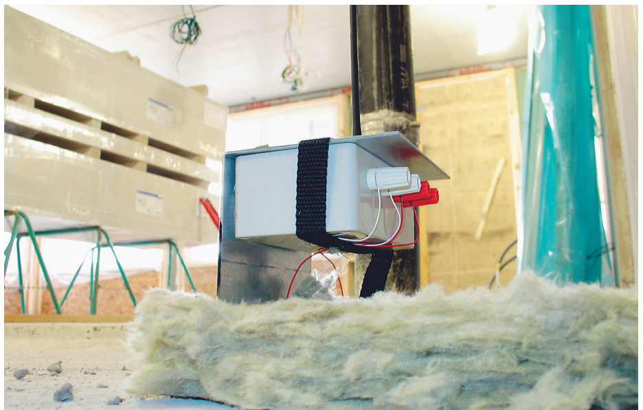
Figur 1: Isoleringen täcker mätpunkten och temperatursvängningarna reduceras.
