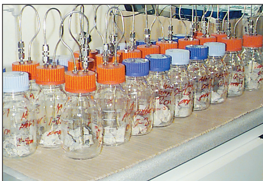
Mätning av tio VOC-profiler i en byggnad med SBS-besvär. På varje mätställe har cirka 100 g betongprov tagits ur på tre djup, ungefär 0–1 cm, 2–3 cm samt 4–5 cm.
