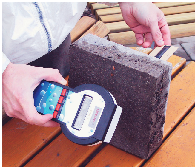
Handhållen avläsningsenhet samt magnoelastisk fuktsensor som utvecklats vid Imego, Institutet för mikroelektronik i Göteborg.
